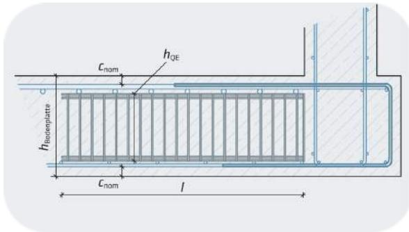
Die Elemente werden zwischen den unteren und oberen Lagen der Biegebewehrung verlegt und dienen gleichzeitig als Abstandhalter.
